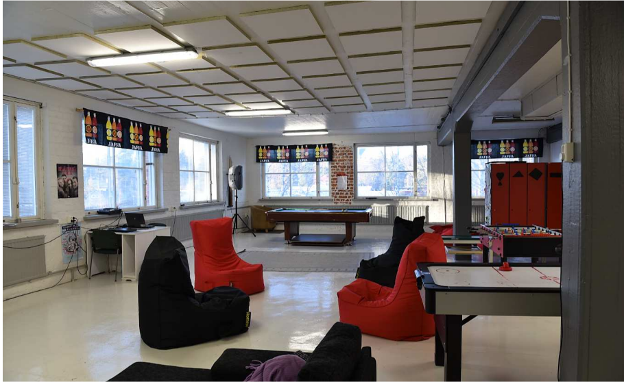
Kuva: Kuvan huone on nuorisotiloiksi remontoitussa III-kerroksessa. Pinnat on maalattu ja kattoon kiinnitetty levyt äänimaailman pehmentämiseksi.
